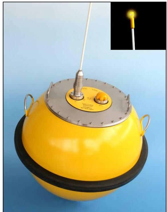
0.7 м DWR-MkIII с дополнительной противокоррозийной окраской корпуса
